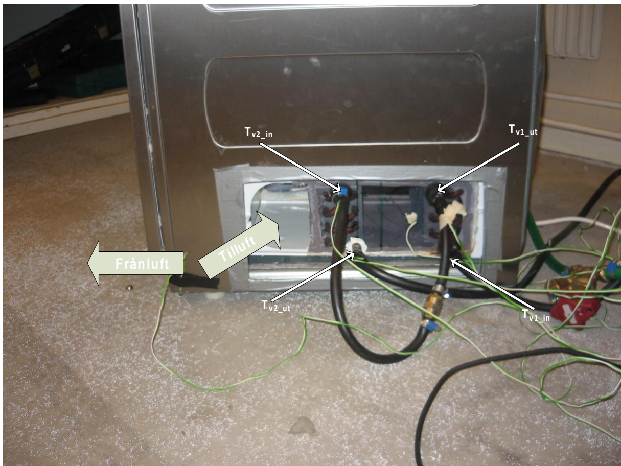
Bild 1 visar hur värmeväxlarna integrerades i torktumlaren inför försöksserie 2. Pilarna visar mätpunkter för varmvattentemperaturer och från- och tilluftsvägar.
