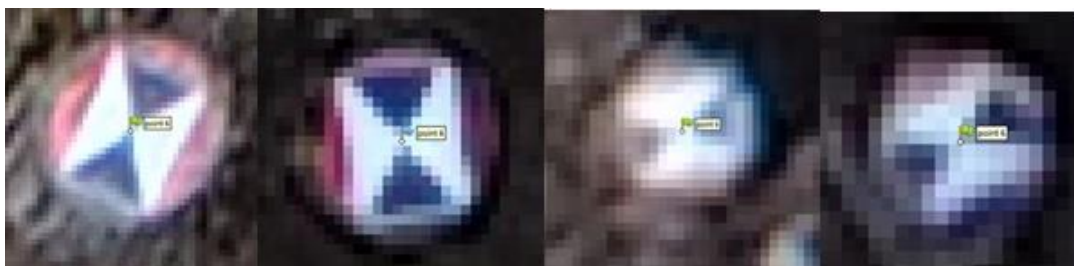
Figur 17. Tolkning av markstöd vid olika flyghöjder; 50, 75, 100 och 120 m.
