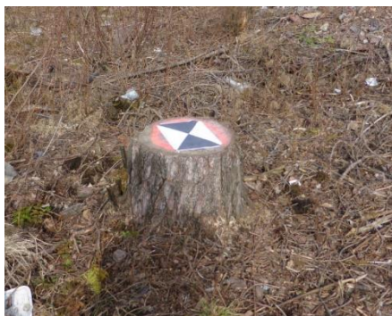
Figur 5. Exempel på markstöd, punkt 6 vid en stubbe.
