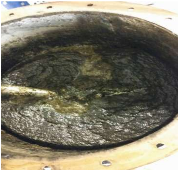
Figur 20: Toppen på en av reaktortankarna, fyllt med ett ca 3 cm tjockt lager.
