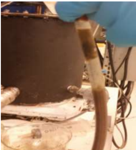
Figur 21: Luftbubbla i slang vid matning, bild av Elisabet Edvardsson.
