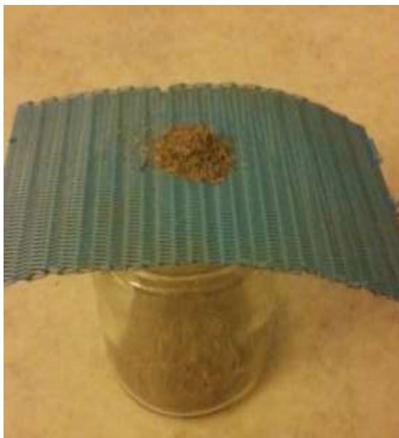
Figur 6: Silning av gräs som ska användas i försöket, bild av författare.
